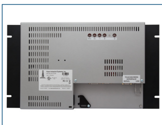
Vista trasera del monitor de montaje en bastidor de 15".
